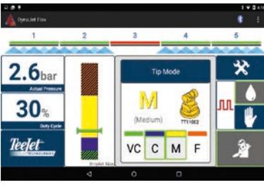
Il sistema DynaJet Flex 7140 offre un rigoroso controllo delle dimensioni delle goccioline grazie alla tecnologia Pwm e consente di dissociare la pressione di nebulizzazione e la portata dei bocchigli, dissociando quindi pressione di esercizio, dimensioni delle goccioline e dose di applicazione.
