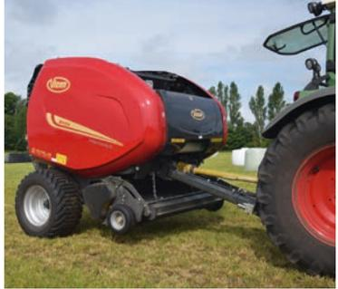
Per semplificare la vita degli operatori, sono stati adottati una serie di dispositivi per il caricamento della camera che si sono via via modernizzati. Sulle presse dotate di sistema AFC (Auto Feed Control) il sistema di aggancio standard è sostituito da un timone specifico, dotato di due bracci telescopici governati idraulicamente.
