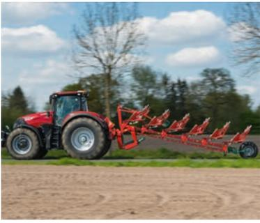
L'aratro portato 2500 i-Plough è stato pensato per semplificare l'utilizzo e garantirne la sicurezza. Al lavoro, tutte le regolazioni importanti sono modificabili tramite il terminale Isobus della cabina. Le impostazioni possono poi essere memorizzate in modo da poter essere recuperate immediatamente.
