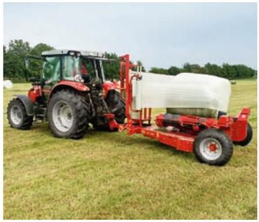
Nel sistema Hsp (High Speed Pack) il dispositivo brevettato OptiSpeed (sistema di regolazione automatica della velocità della piattaforma di fasciatura), unito al sistema DuoWrap a doppio estensore, consente di ottimizzare i ritmi di lavoro delle fasciatrici a piattaforma girevole.
