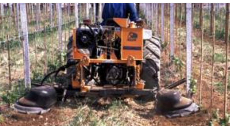
>> Lavorazione sulla fila realizzata con trattore di media potenza e senza cabina.
