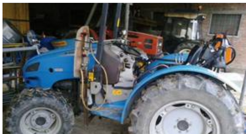
>> Piccola trattrice equipaggiata con barre da diserbo ventrali.
