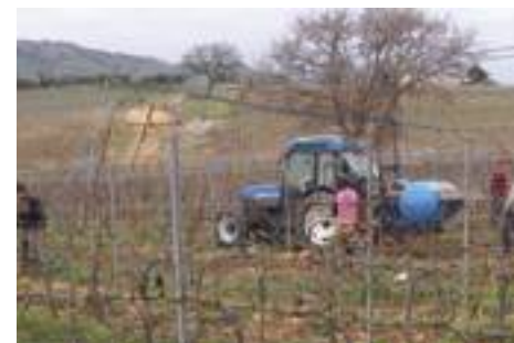
>> Trattore usato per azionare il compressore per le forbici pneumatiche. Serve poca potenza, cabina "superflua".
