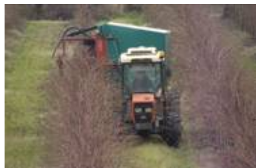
>> 2 - Pre-potatura meccanica con rifinitura al seguito in un vigneto. Non serve grande potenza.
