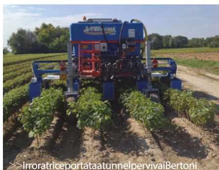
>> Irroratrice portata a tunnel per vivai Bertoni
