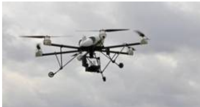
■ Le unità aeree sono sistemate su quadricotteri (AirRobot AR100X6).
