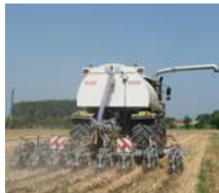
Vogelsang: strip tillage con interrimento reflui xTill.
