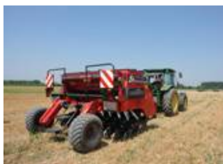
■ Emmeemme: seminatrici Semeato a righe TDNG 300 E (a sinistra) e di precisione SPE 06 VS.
