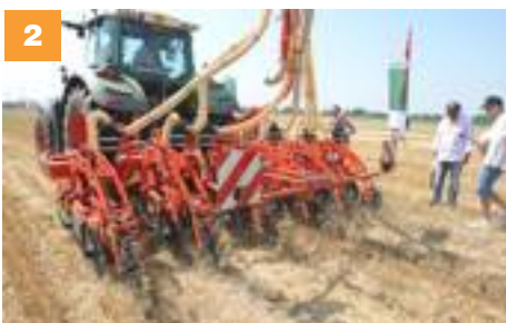
■ Emmeemme: seminatrici Semeato a righe TDNG 300 E (a sinistra) e di precisione SPE 06 VS.
