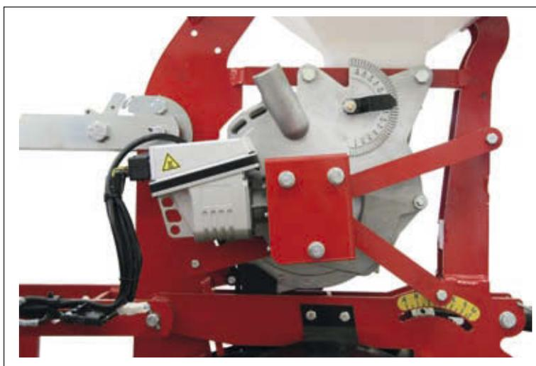
■ Il nuovo dispositivo permette la gestione elettrica della trasmissione e della distribuzione della seminatrice.
