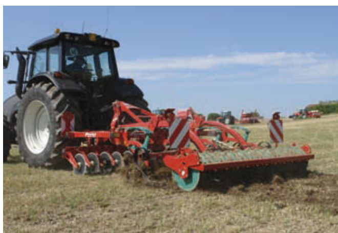
■ La novità assoluta del CLC Pro Cut è la dischiera di taglio frontale Fcd.
