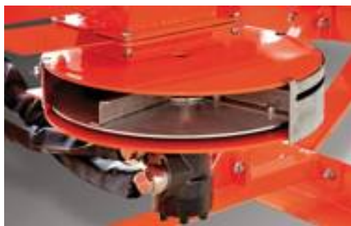
■ Esempio di sistema di distribuzione a disco azionato tramite circuito idraulico.
