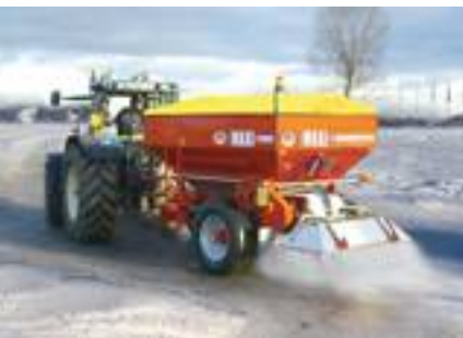
■ Esempio di spargisale trainato. Nella foto è ben visibile il ruotino volumetrico sopra la ruota dell'operatrice per il dosaggio della distribuzione e il deflettore sopra il disco posteriore.
