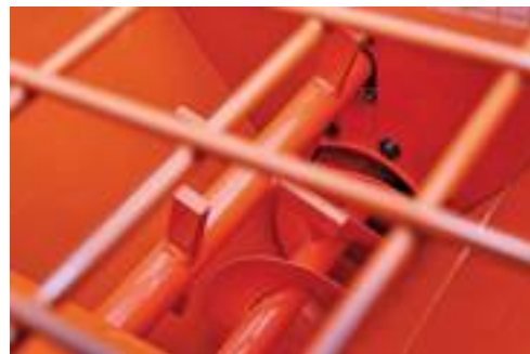
■ Particolare dell'albero frantumatore all'interno del serbatoio.
