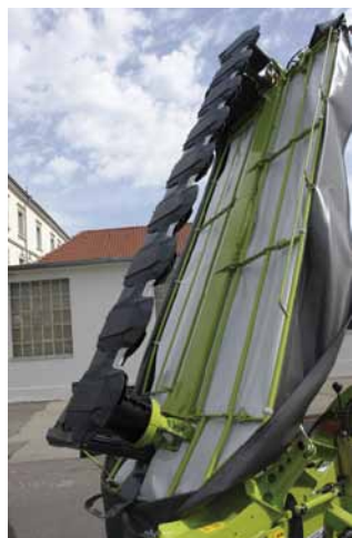
■ La nuova barra falciante Max Cut è lubrificata a vita.
