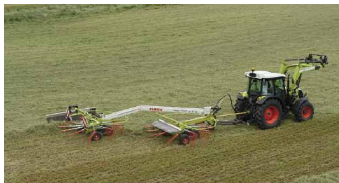
■ I nuovi Liner compatti offrono, oltre al deposito semplice dell'andana, anche la funzione Twin per il deposito doppio dell'andana stessa.
