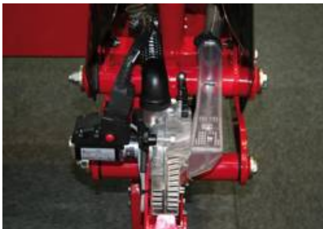
■ Dettaglio elemento di semina azionato elettricamente con flangiatura diretta al disco dosatore.
