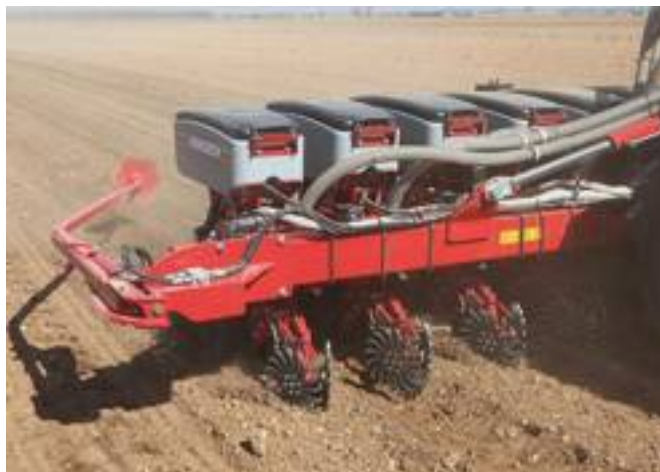
■ Seminatrice pneumatica a pressione in lavoro con dischi spargi residui in funzione, i quali fungono anche da spargi zolle.
