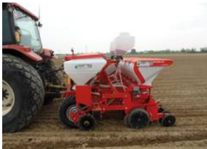
■ Seminatrice con elemento di semina azionato elettricamente funzionante a depressione.
