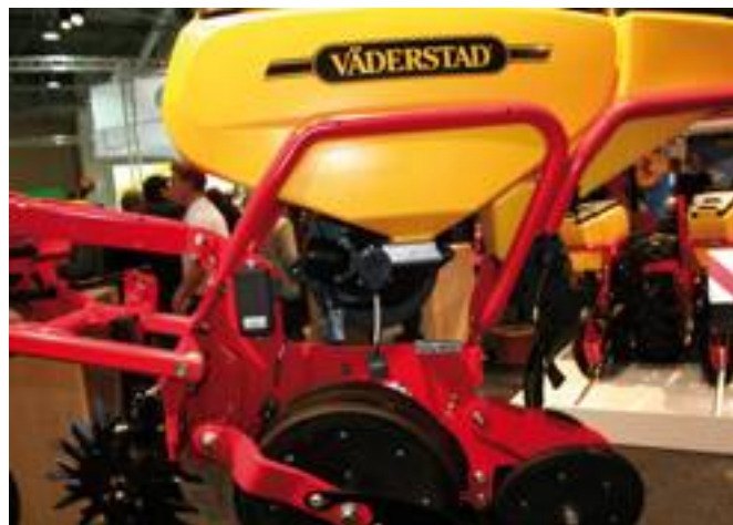
■ Elemento di semina con dosatore azionato elettricamente e operante in pressione.
