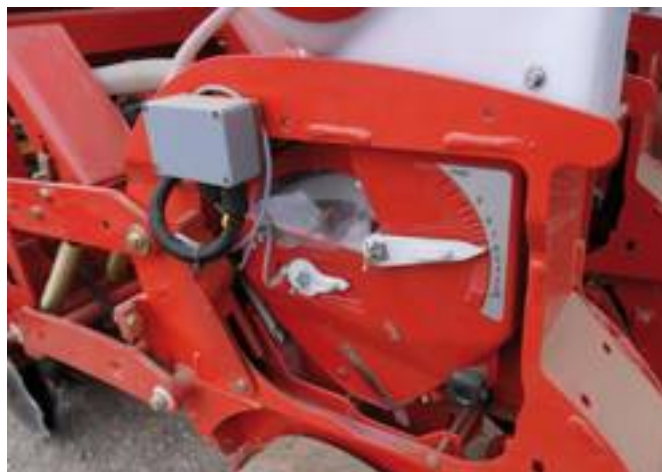
■ Dettaglio del sistema elettronico di azionamento e controllo.
