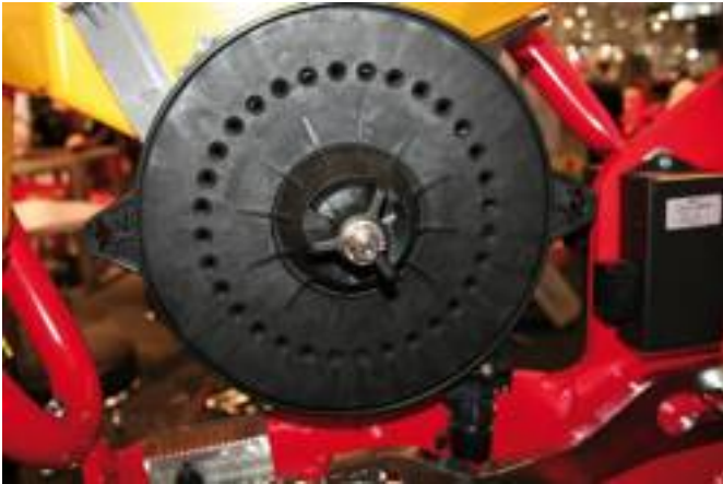
■ Dettaglio del disco dosatore realizzato in materiale plastico e di dimensioni più contenute rispetto a quanto fino ad ora prodotto.
