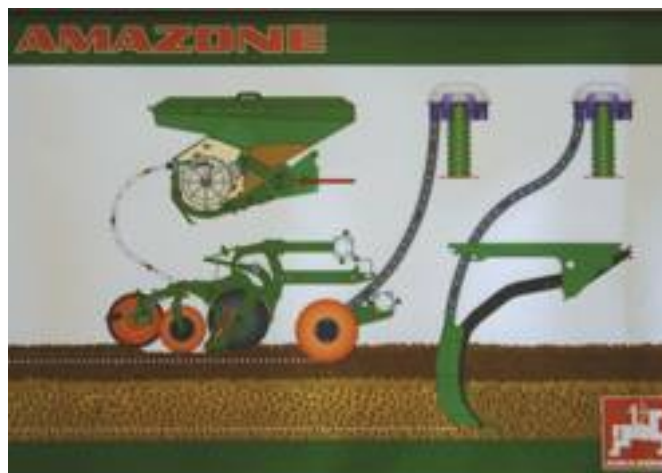
■ Schema costruttivo e di funzionamento della seminatrice con dispositivo dosatore centralizzato.
