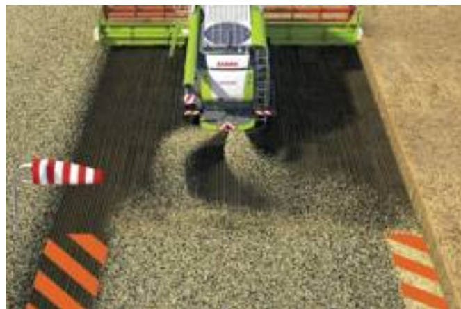
■ La regolazione automatica della direzione di lancio è disponibile su tutti i modelli Lexion con distributore radiale.
