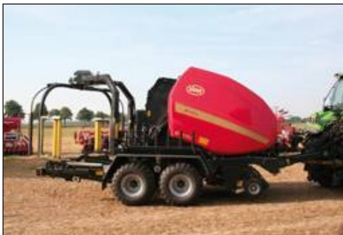
[ Foto 4 - La rotopressa - fasciatrice Vicon RV 4216 si caratterizza per la completa gestione Isobus e per una capacità di lavoro superiore rispetto alla serie precedente.
