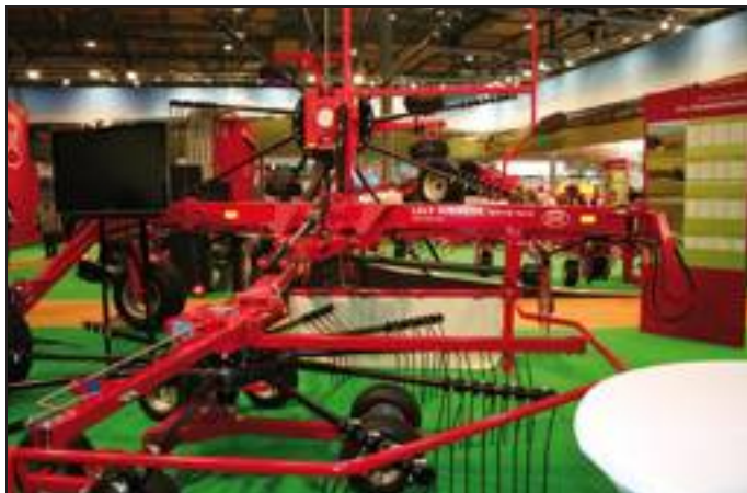
[ Foto 3 - Il ranghinatore Lely Hibiscus 815 CD Vario permette di regolare la propria larghezza di lavoro in modo telescopico. Inoltre presenta un carrello di adattamento al terreno con tre serie di ruote.
