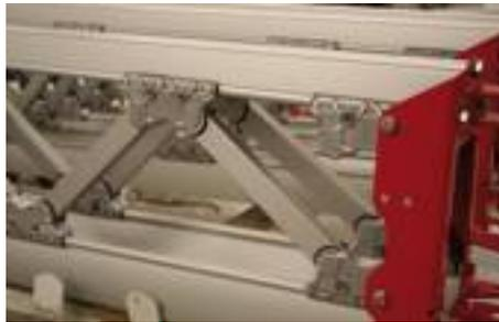
Componenti della barre incollati con colla nera di derivazione aeronautica.
