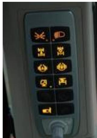
Sul montante destro troviamo le regolazioni secondarie delle sospensioni, del bloccaggio differenziali e di altri dispositivi di uso meno frequente.
