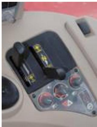
Controlli meccanici per le velocità della presa di potenza. Sotto, vediamo le regolazioni secondarie del sollevatore posteriore.
