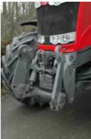
Il sollevatore anteriore integrato nel telaio del trattore è una delle qualità più apprezzate dai proprietari.
