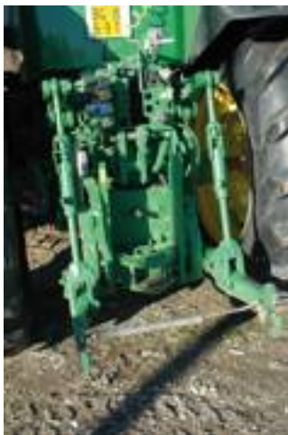
Sollevatore elettronico con oltre 9 tonnellate di portata e un buon controllo dello sforzo.
