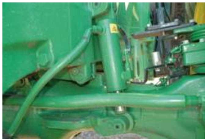
Ponte sospeso sempre attivo, una caratteristica di John Deere.
