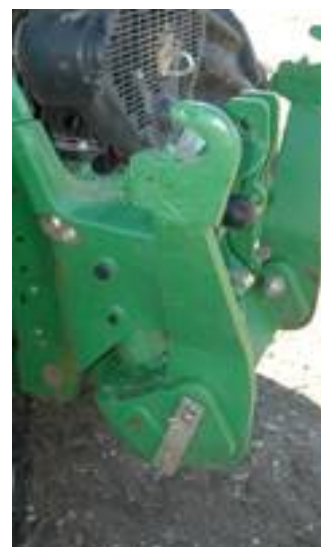
Ponte sospeso sempre attivo, una caratteristica di John Deere.
