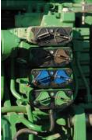
La macchina acquistata dai Cornale monta quattro distributori, il numero standard per il 7230R.
