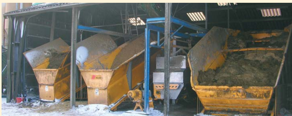
● Foto 5 – Container fissi per lo stoccaggio temporaneo dei foraggi. Al centro si nota il vagone miscelatore/distributore in posizione di miscelazione.
