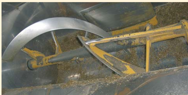
● Foto 9 - Sistema di miscelazione ad aspo a bassa richiesta di potenza, azionabile a batteria.
