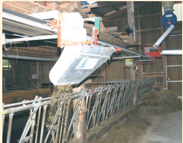
● Foto 2 - Sistema automatico di tipo stazionario per la preparazione/distribuzione dell'unifeed a gruppi
