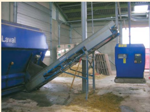
● Foto 3 – Miscelatore fisso e vagone distributore di tipo sospeso.
