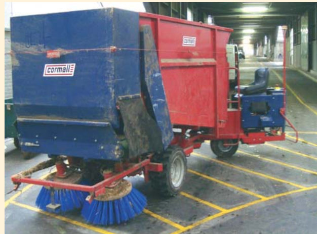
● Foto 4 – Vagone automatico di tipo semovente per la distribuzione a frequenza programmabile di razioni unifeed.
