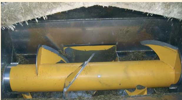
● Foto 10 - Sistema di miscelazione a singola coclea orizzontale .
